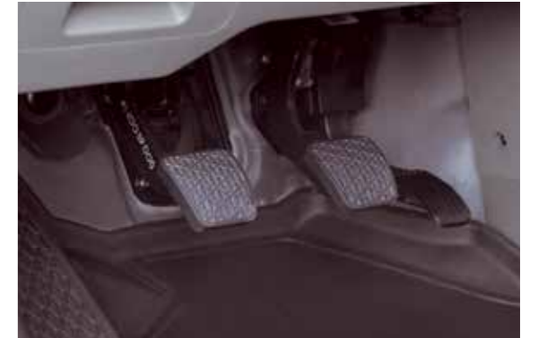
Hidrolik Fren Asistanı (HBA). Ani frenleme anında ekstra yardım sağlar.
